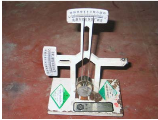
图 2-11 雷氏夹膨胀值测量仪
