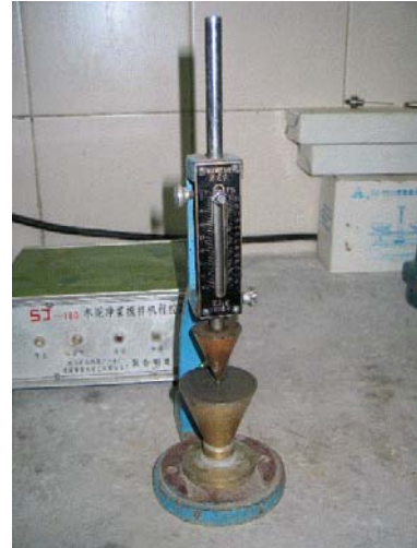
图 2-7 净浆标准稠度与凝结时间测定仪
