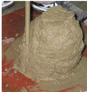
图4-2 塑性混凝土坍落
