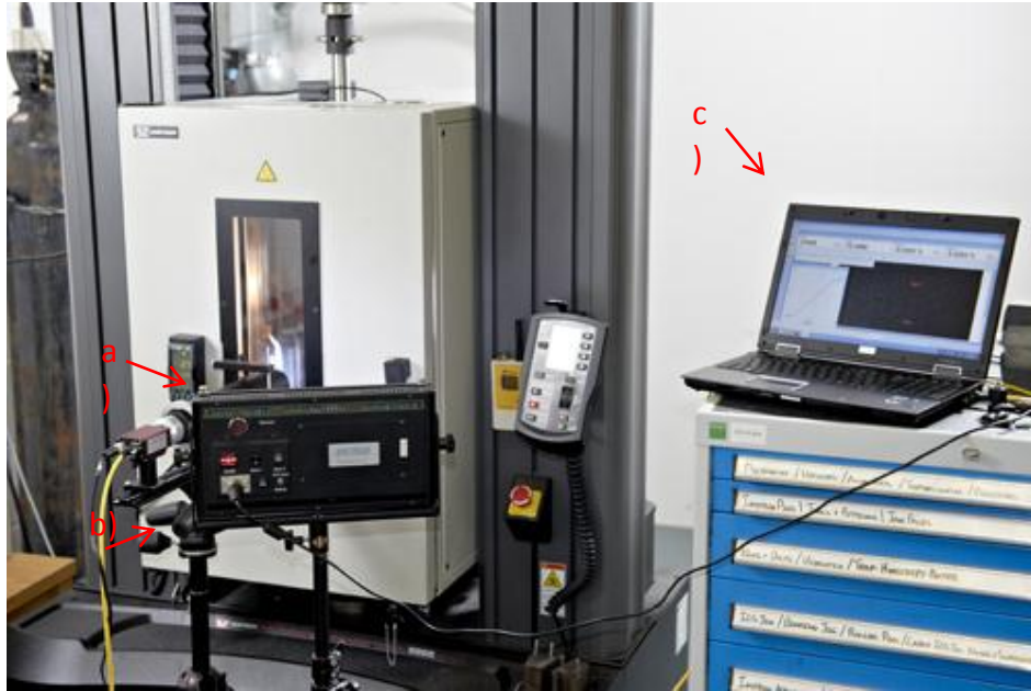
图 2-1 非接触视频测量仪在力学实验中的应用
