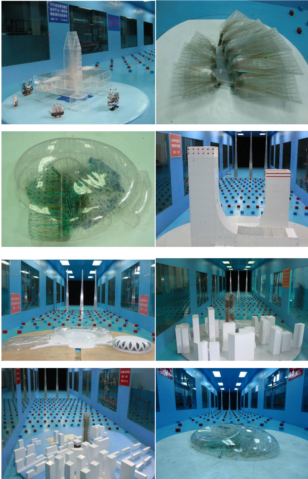
图 2-19 各种模型表面测压试验
